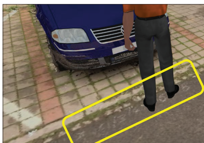
Obr. 6 Postavení chodce v simulačním programu vůči bodovému mračnu okolí. Fig. 6 Pedestrian's position in simulation software in relation to point cloud of the scene.
